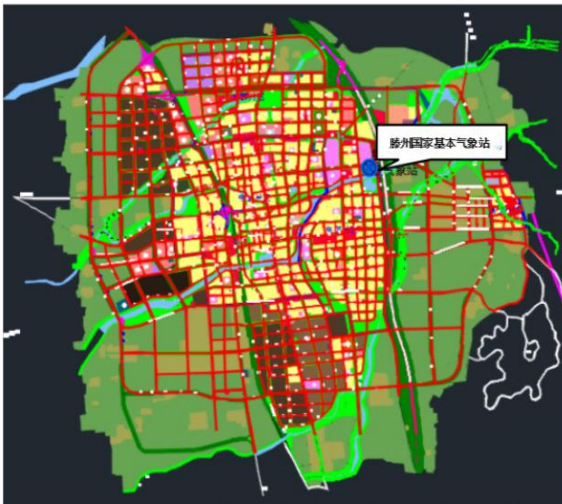
附图 6：滕州国家基本气象站周边控制区建筑高度控制图
